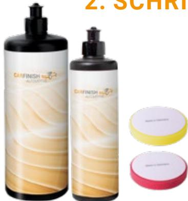
Hocheffiziente Schleifpaste fein, schwarze Kappe, zur Verwendung mit Polierschwamm gelb (weich) oder rot (superweich, bei Hologrammen). Optimal zur Entfernung von Mikrokratzen, Vermattungen und Hologrammen sowie als Finish bei Staubeinschlüssen, Sprühnebel und Beilackieren. Empfohlen im 2-Schritt-System mit 1200 FastCut. Geeignet für kratzfeste Klarlacke. Abtrag 5/10, Glanzgrad 10/10.
