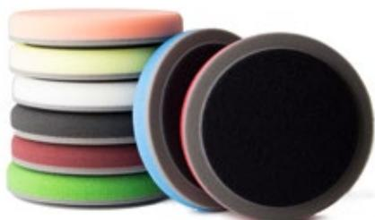
Hochwertige Polierschwämme in verschiedenen Härtegraden. Durch 2-Komponenten-Aufbau behält der Schwamm auch im Randbereich eine höhere Rücken-Festigkeit und ermöglicht dadurch eine gleichmäßigere Verteilung des Arbeitsdrucks. 150 mm x 25 mm. Schwarzer Velours.
