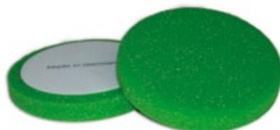
Harter Polierschwamm für hohe Abtragsleistung, z. B. in Verbindung mit Politur 9374, 9375 oder 50417 von 3M. Schwamm und Klebstoff von führenden deutschen Herstellern, produziert in Deutschland. 150 mm x 25 mm, Velours zurückgenommen auf 125 mm zum Schutz der Oberfläche. Arbeitskante abgerundet. Aufdruck "Made in Germany".
