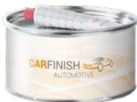
Extrem leichter Polyester-Füllspachtel, Farbton beige. Aufgrund moderner Füllstoffe bis zu 40 % höherer Abtrag als bei gewöhnlichen Spachtelmassen, dadurch erhebliche Zeitersparnis vor allem bei großen Flächen. Haftung auf allen Metallen, Holz und Polyesterlaminaten. Dose mit gleicher Füllmenge wie 2 kg herkömmlicher Spachtel. Gewicht nur 1,3 kg, inkl. Härterpaste (Zugabe 2 - 3 %).
