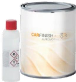
Klassischer, bewährter und zeitsparender 2K-Spritzspachtel auf Polyesterbasis zum Füllen von Unebenheiten, grob vorgearbeiteten Reparaturstellen, extremen Schleifriefen etc. Exzellente Haftung auf Stahl und geschliffenen Altlacken. 4 % vom mitgelieferten Spritzspachtel-Härter zugeben, bis zu 10 % Universal-Verdünnung und in 1,5 bis 2 Spritzgängen auf 250  $\mu$  bis zu maximal 400  $\mu$  Trockenfilmstärke auflackieren.
