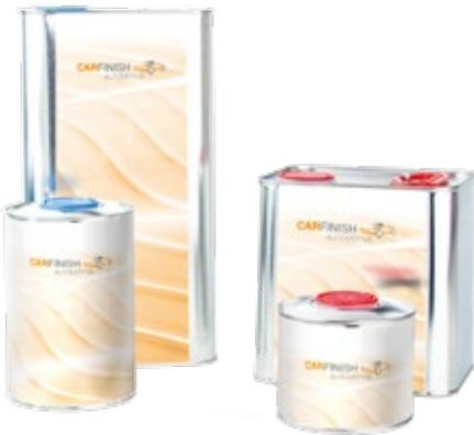
2K-Ultra High Solid-Klarlack 2:1 für Ganzlackierung und Spotrepair. Extrem kurzer Lackierprozess bei 60 °C Objekttemperatur, keine Ablüftzeit und nur 10 - 12 Min. Trocknung. Die Applikation erfolgt in 2 Gängen ohne Zwischenablüftzeit.
