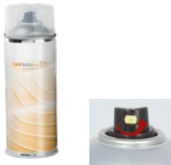
Beispritzverdünnung für Beilackieren ohne sichtbare Übergangszonen zwischen Alt- und Neulackierung. Verwendbar für Zweischichtlackierungen (2K-Klarlack) sowie Einschicht-Decklacke. Durch sein schnelles und gleichmäßiges Anlöseverhalten sowie den verstellbaren Sprühkopf sorgt unser Beispritzblender für hervorragende Ergebnisse ohne Abriss- oder Übergangskanten bzw. Sprühnebel. Reduziert den Polieraufwand.
